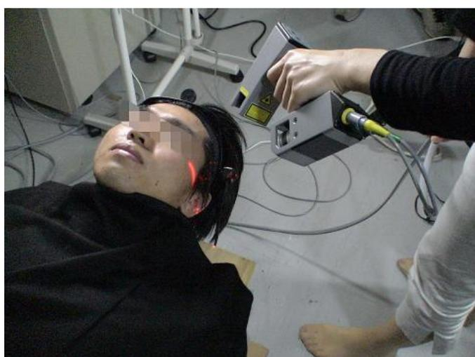
ボタンを深く押し(一段目でレーザー発射・二段目でスキャン開始)ゆっくりと顔面をスキャンする。
