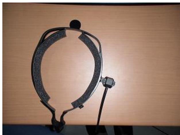
図一4 トランスミッター(磁場発生器)
